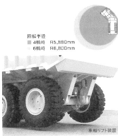
図-3 車軸リフト装置
