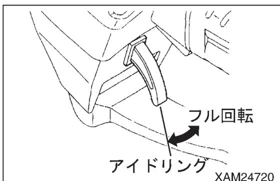
☞ アクセルレバーは、単独で操作してもコントロールバルブ流量制御およびエンジン回転数を調整することはできません。各操作レバーを操作したまま、アクセルレバーを引いていくと、エンジンアイドルリング回転状態でクレーンが作動を始め、さらにアクセルレバーを引いていくと、エンジン回転数が高くなり、クレー
