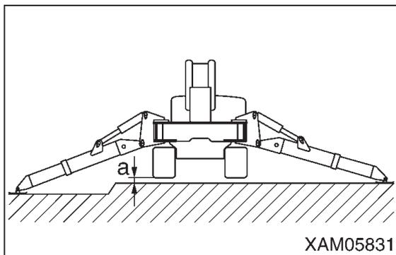
定格総荷重表の「アウトリガ最大張出」の状態は、下図の状態を示します。
