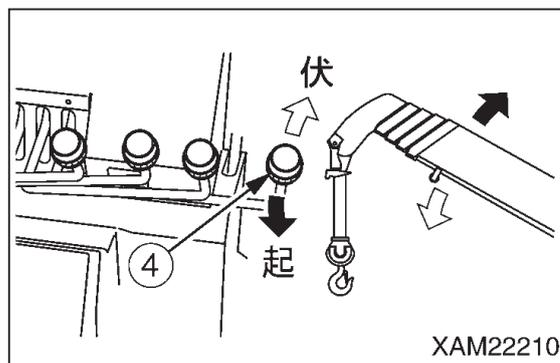
☞ ブームの起伏速度は、ブーム起伏レバーおよびアクセルペダルのストロークによって調整してください。
