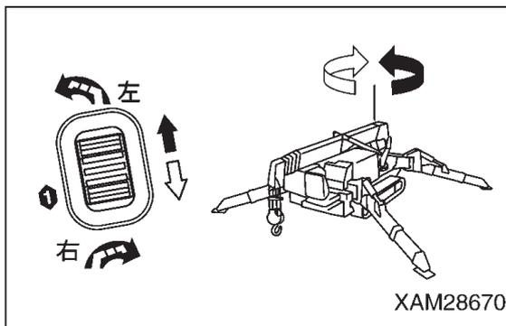
14. フック格納/設定スイッチを押したままアクセルレバーを操作し、フックが正常に格納されるか確認してください。
