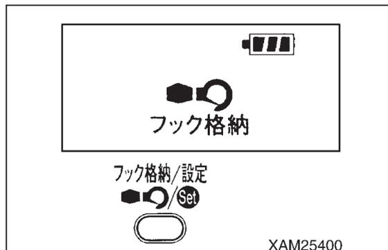
3. フック格納/設定スイッチを押したままの状態、アクセルレバーをゆっくり引いてください。フック (4) が上がり、所定の位置に格納されます。
