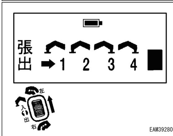
8. 操作レバーの操作中、同時にアクセルレバーの操作中、同時にアクセルレバーをゆっくり引いたり戻したりし、No.1 アウトリガがアクセルレバーの操作量に対応した作動速度になるか確認してください。
