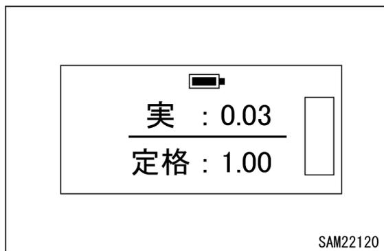
2. 負荷が加わった場合に、負荷率のバーメーターが実荷重の変動に合わせて変動するか確認してください。
