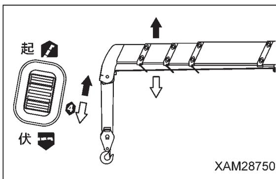
6. ブーム起伏操作レバーを「起」側（上方）に操作し、ブームを十分な角度（60度程度）に起こしてください。
