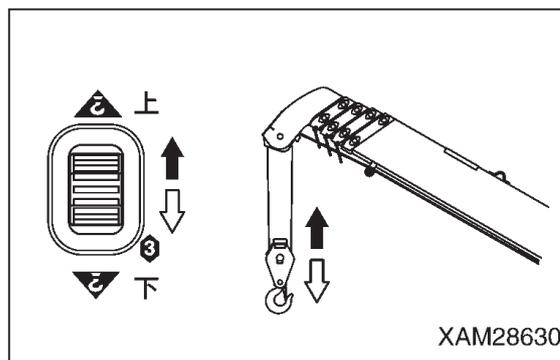
8. フック巻上、巻下操作レバーを「下」側（下方）に操作し、フックをできるだけ巻き下げてください。
