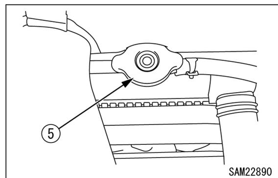
5. ラジエータの内圧が抜けたら、さらにラジエータキャップ (5) を押しながらストoppaに当たるまで回し、ラジエータキャップ (5) を外してください。
