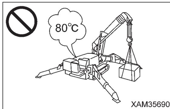
高揚程でのフック巻き上げ・巻き下げ操作やアクセルを吹かした状態でのクレーン作業を連続して行くと、作動油の温度が上がりやすくなるので、とくに注意してください。
