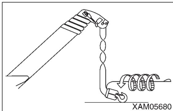
6. エンジンを始動させ、ブーム起伏レバーを「起」(手前側に引く)側に操作し、ブーム起伏角度を最高にしてください。
