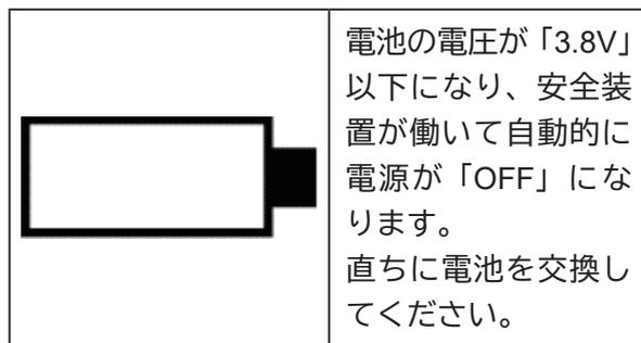
[2] クレーンモードでの液晶表示部の表示点検
