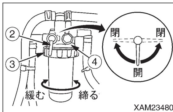
2. ヘッド(4)部のリテーナリング(3)を左方向に回して緩め、ポット(1)をヘッド(4)部から取り外してください。
