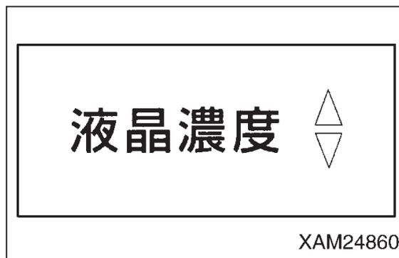
2. 液晶濃度が決定したら、フック格納 / 設定スイッチを押してください。1項で調整した濃度になり、初期モード設定画面に戻ります。
