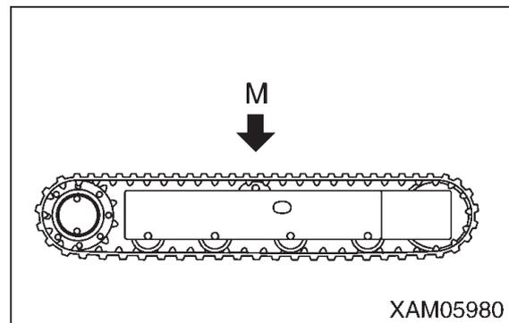
2. 「5.1.13 アウトリガの設置操作」の項を参照してアウトリガを設置し、足回りを地上から 50mm 程度浮かせてください。
