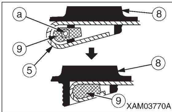
3. ウインチレバーをゆっくり「上」(手前に引く) 側に操作して、ウインチドラム (8) にワイヤロープ (5) を巻き取ってください。このとき、ワイヤロープは、乱巻き防止用ローラ (B) とウインチドラムの間に巻き込むようにし、ブーム先端より先に 10m 程度ワイヤロープを残してください。
