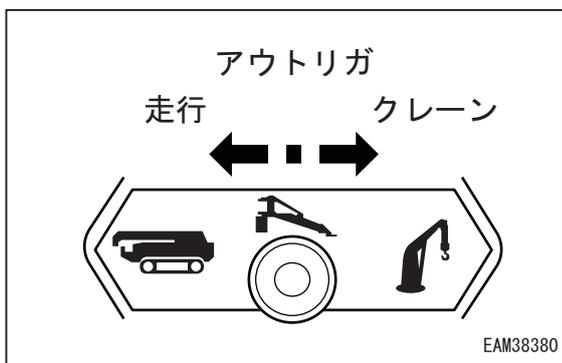
6. アウトリガ操作盤内のアウトリガスイッチ(5)を「入」位置にし、アウトリガが作動しないことを確認してください。
