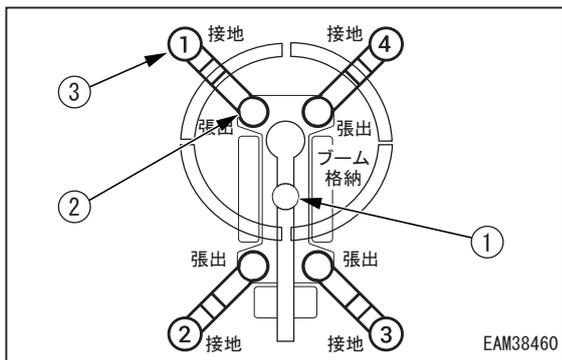
アウトリガ表示部内のブーム格納ランプ (1)、アウトリガ張出ランプ (2)(4 個)、アウトリガ接地ランプ (3)(4 個) のすべてのランプが緑色に点灯しています。
