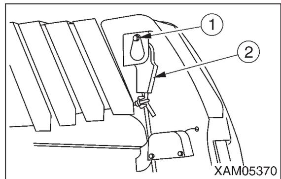
5. ワイヤロープの端を、手順1で調べたフックブロックのねじれている反対の方向(ウエッジソケットから手を離れたときに、自然に戻ろうとする反対の方向)に、フックブロックのねじれた回数の「n」(ワイヤロープの掛け数)倍を強制的にねじって取り付けてください。
