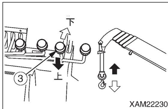
☞ フックブロックを巻き上げ過ぎると巻過を検出し、警報ブザーが鳴り、巻上操作が自動停止します。
