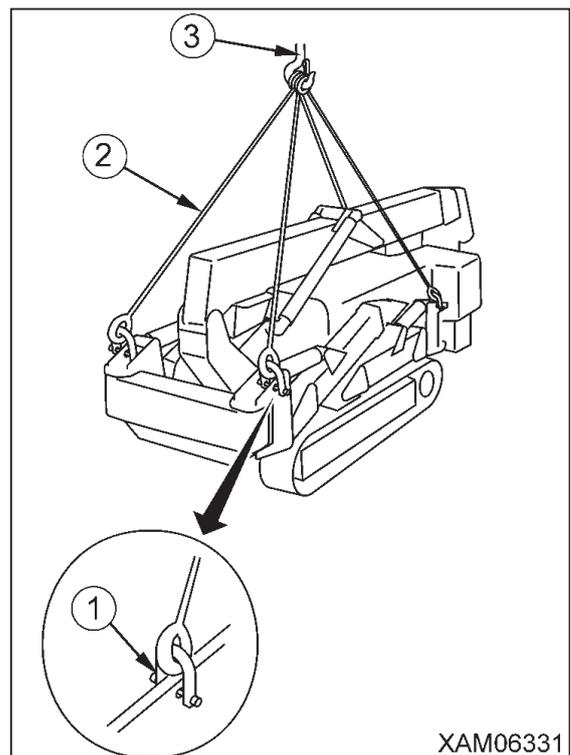
4. 機械が地面を離れた直後(地切り)一旦停止し、機械が安定してからゆっくりと吊り上げてください。
