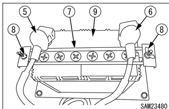
3. ちょうナット(8)を外し、バッテリー取付け金具(7)を取り外し、バッテリー(9)を取り外してください。
