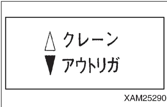
5. 4項の操作後、「アウトリガマーク」が表示され、その後、「アウトリガ接地モード」が表示されるか確認してください。
