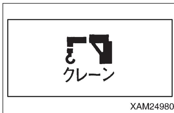
3. 液晶表示部に「クレーンマーク」が表示されている間(約2秒間)に、速度/モードスイッチを2秒間押してください。液晶表示部に「クレーンモード」と「アウトリガモード」の選択画面が表示されます。
