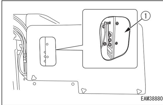
2. 受信機ボックス (1) に亀裂や損傷などがないか点検してください。
