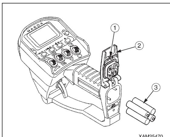
3. 電池収納部から電池 (3) を取り出し、新品の電池を挿入してください。
