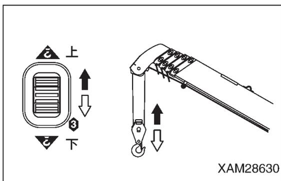
2. フックが自動停止した後、フック格納/設定スイッチを押してください。送信機の液晶表示部に「フック格納」が表示されます。
