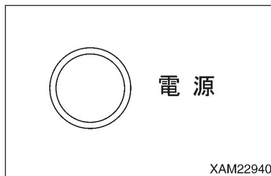
☞ 電源供給設備と本機械への電源接続作業完了後、電源供給設備側のブレーカを「ON」(入)位置にしても点灯しない場合は、電源供給設備側電源を点検してください。
