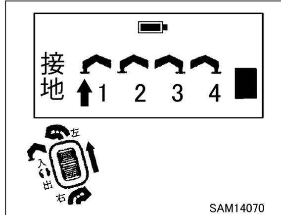
7. 「アウトリガ張出モード」に設定するときには、「アウトリガ接地モード」画面の状態です。速度/モードスイッチを押してください。このとき、「アウトリガ張出モード」が表示されるか確認してください。
