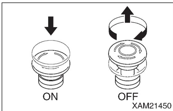
☞ エンジンを緊急停止した後、エンジンを再始動するときは、エンジン非常停止スイッチを必ず「OFF」位置に戻してから、エンジンの始動を行ってください。
