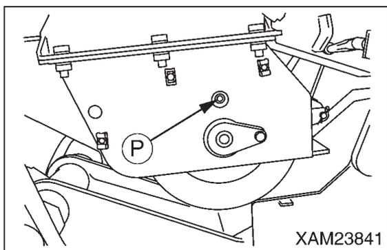
5. 六角棒レンチを使用して、プラグ(P)を外してください。減速機ケース内のギヤオイルが排出されます。
