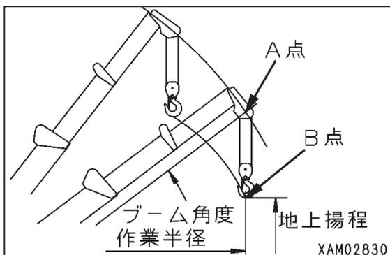
2. 「作業半径 / 揚程図」は、無負荷の状態を表し、ブームのたわみは含まれていません。荷を吊った場合、実際にはブームがたわみ、作業半径が若干広がります。作業半径が広がると、定格総荷重の値は小さくなりますので、実際にクレーン作業を行うときは、「作業半径 / 揚程図」より余裕を持った作業計画を設定してください。
