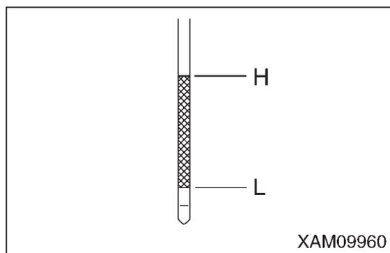
7. オイルが「L」までないときは、給油口キャップ (F) を取り外し、給油口からエンジンオイルを補給してください。
