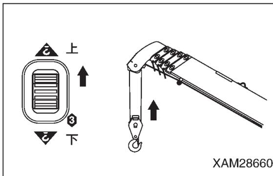
13. 6項~12項の操作レバーの操作中、速度/モードスイッチを押し、それぞれ「微速コマンド」、「増速コマンド」でクレーンの作動を行い、設定した「微速コマンド」、「増速コマンド」に対応した作動速度（微速、増速）になるか確認してください。
