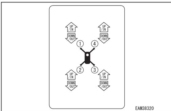
4. 作業切換スイッチ (アウトリガ起伏/伸縮) を「アウトリガ伸縮」位置にしてください。
