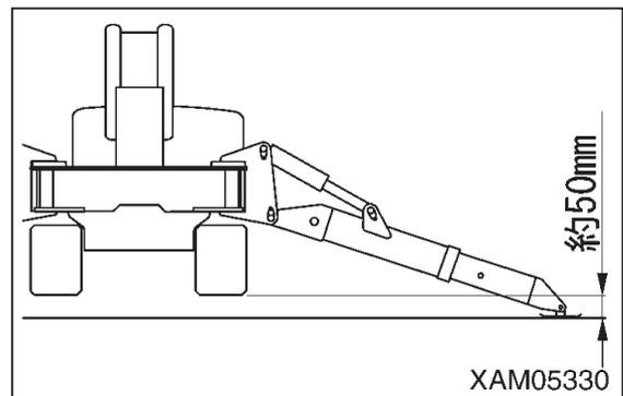
9. 機械が地上より約50mmの高さまで浮き上がった後、水準器の気泡の位置を見ながらアウトリガススイッチを操作して、機械が水平になるように調整してください。
