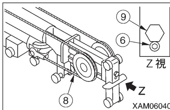
2. No.5 ブーム引き込み用ワイヤロープ (5) の調整ナット (4) を左右共 2 回転増し締めしてください。
