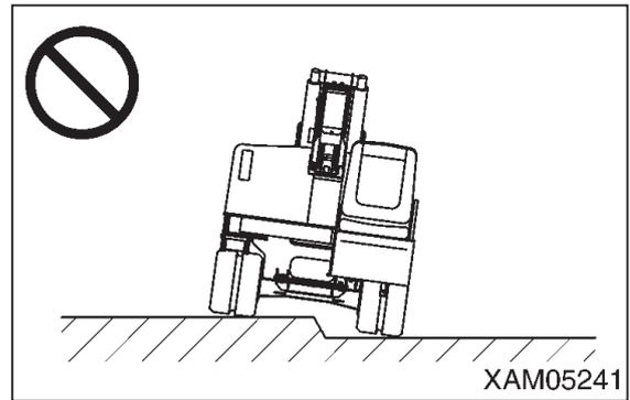
やむを得ず乗り越えるときは、できるだけ低速で走行してください。また、機械が極端に傾く（10度以上）障害物の斜め乗り越えをしないでください。
