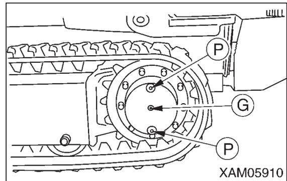
2. 走行モータ減速機ケースの油量点検プラグ (G) を外し、オイルがプラグ穴から出てくるか点検してください。
