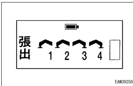
☞ 「アウトリガ張出モード」と「アウトリガ接地モード」は、速度/モードスイッチを押すごとに切り換わります。
