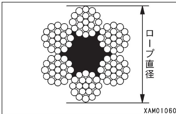
☞ 直径が8mmのワイヤロープは7.5mmで交換してください。
