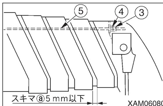
2. 手順 1、2 項の操作・測定後、引き込み用ワイヤロープがたるんでいたり、スキマ (a) が 5mm 以上開いている場合は、再度調整をしてください。
