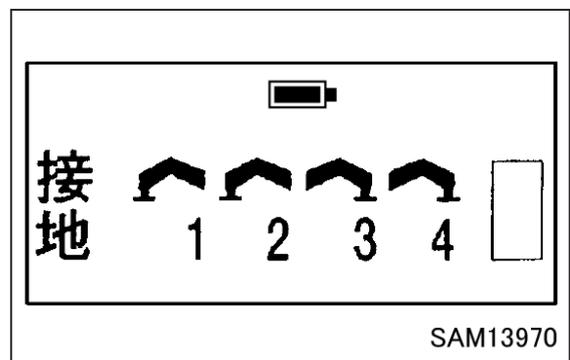
2. アウトリガ操作レバーを「入」側(上方)に操作してアクセルレバーをゆっくりと引いてください。
