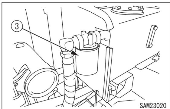
5. フィルタ台を洗浄し、新品のフィルタカートリッジ (3) のパッキン部およびねじ部に清浄なエンジンオイルを塗って (グリースを薄く塗ってもよい) 取り付けてください。
