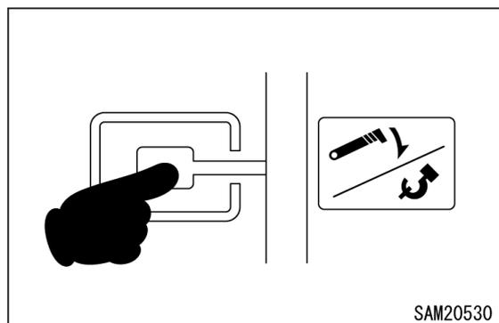
9. モニタのフック格納スイッチ (3-2) を押しながらいんチレバー (3) を「上」(手前側に引く) 側に操作し、フックブロック (4) をブーム先端下部に格納してください。
