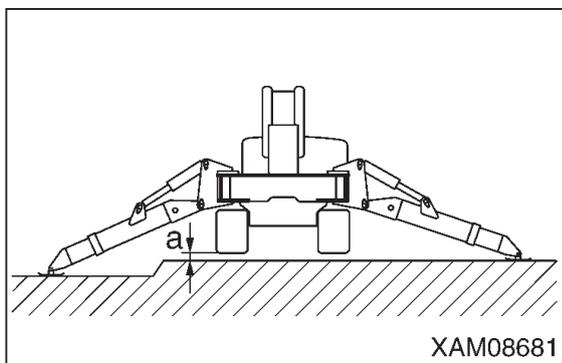
定格総荷重表の「アウトリガ中間張出」状態は、下図の状態を示します。
