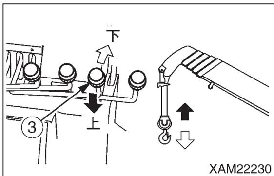
☞ ウインチの巻き上げ、巻き下げ速度は、ウインチレバーおよびアクセルペダルのストロークによって調整してください。
