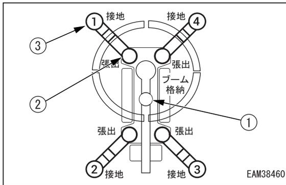
4. 4基すべてのアウトリガロータリを外側に回転させ、ポジションピン (4) を確実に挿入してください。
