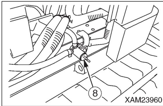
7. ドレンバルブ (8) を開いて冷却水を排出し、排水後、ドレンバルブ (8) を閉じてください。
