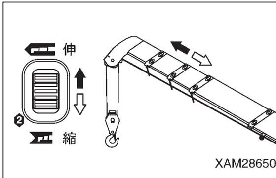
12. 6項~12項の操作レバーの操作中、同時にアクセルレバーをゆっくり引いたり戻したりし、クレーンの各作動がアクセルレバーの操作量に対応した作動速度になるか確認してください。
