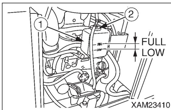
5. 冷却水量が「LOW」レベル以下の場合は、つぎの要領で水道水を補給してください。
