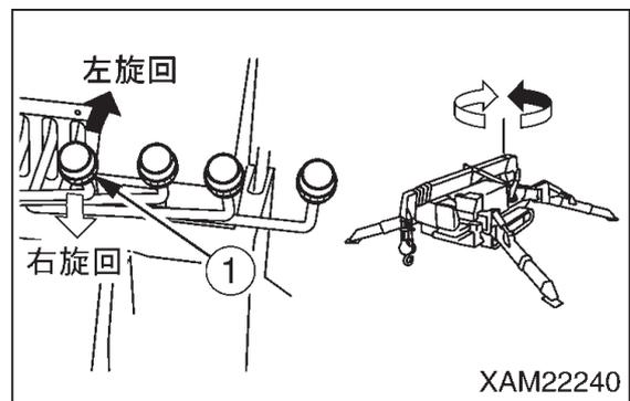
☞ クレーンの旋回速度は、旋回レバーおよびアクセルペダルのストロークによって調整してください。
