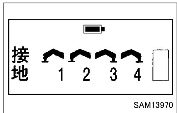
11. 旋回 / No.1 アウトリガ操作レバーを「出」側（下方）および「入」側（上方）にそれぞれ操作し、No.1 アウトリガが操作レバーの操作に対応した作動をするか確認してください。
