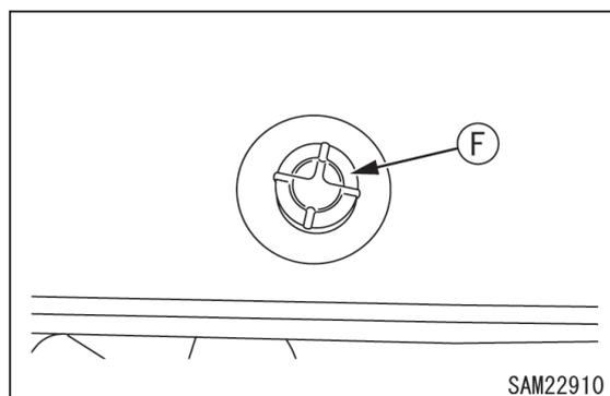
4. 燃料の補給後は、タンクキャップ(F)を回して確実に閉めてください。
