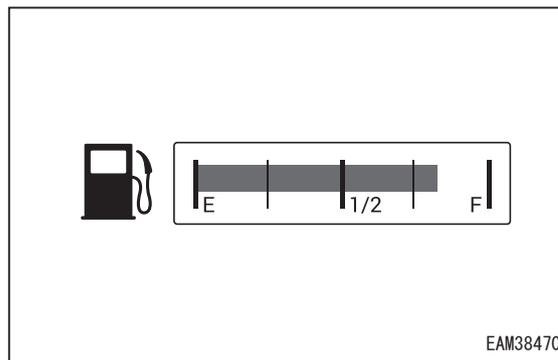
3. 燃料が不足していたら、燃料タンク上面のタンクキャップ(F)を外し、燃料計を見ながら給油口から燃料を補給してください。
