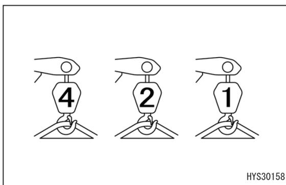
☞ 実荷重が 0.3t 以上の場合、掛け数の切替ができません。掛け数の変更ができない場合、実荷重表示が点滅して知らせます。
