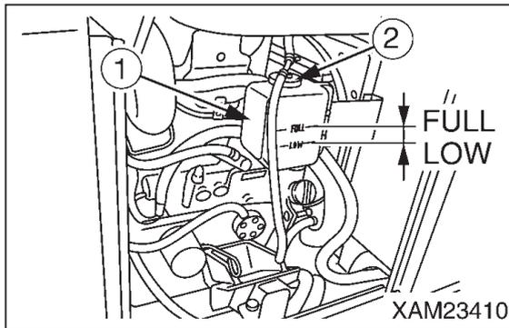
20. リザーブタンク(1)を元の位置に取り付け、給水口から水道水を「FULL」レベルまで給水し、キャップ(2)を確実に取り付けてください。
