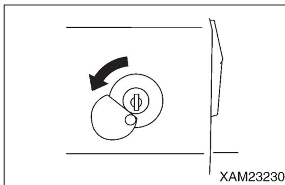
☞ スタータスイッチのキーをスイッチに差し込むときは、カバーを左方向にずらしてスイッチのキー穴が見えるようにし、キーを差し込んでください。
