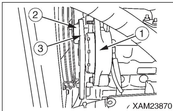
4. 点検の結果、ベルト(3)のたわみ量(a)が標準の数値の範囲にない場合は、張り調整の項を参照しベルト(3)の張りを調整してください。
