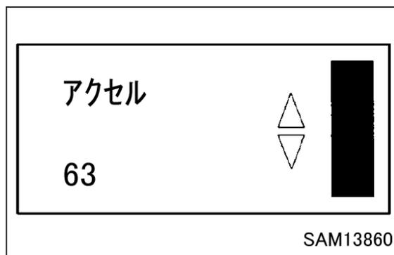
2. 上限速度が決定したら、フック格納 / 設定スイッチを押してください。1項で選択した速度になり、初期モード設定画面に戻ります。
