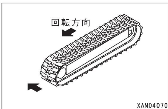
4. 鉄パイプをゴムクローラにかませてから、スプロケットを再度回転させ、ゴムクローラをアイドルに確実に掛けてください。
