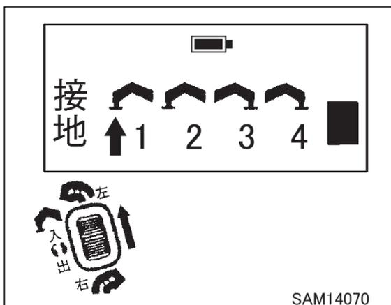
5. 各アウトリガ操作レバーを「入」側(上方)に操作してアクセルレバーをゆっくりと引いてください。
