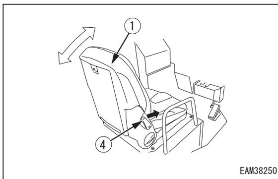
2. バックシート(1)の調整後は、リクライニング調整レバー(4)から手を離してください。
