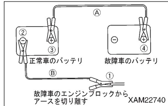
2. 正常機械の (-) 端子に接続してあるブースタケーブル (B) のクリップを外す。
