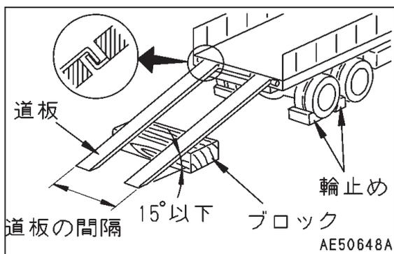
2. 道板は、トラックと機械の中心が一致するように確実に固定してください。
