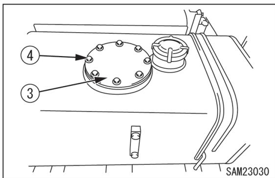
5. 作動油タンク上面のフランジ (3) をおよびサクションフィルタ (5) を取り外してください。
