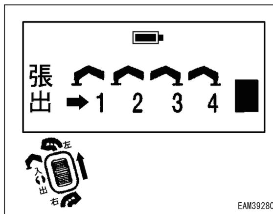
3. 機械が地面に接地したら、アクセルレバーをゆっくりと戻した後、アウトリガ操作レバーから指を離して「中立」位置にしてください。
