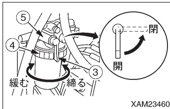
2. ヘッド(5)部のリテーナリング(4)を左方向に回して緩め、ポット(1)をヘッド(5)部から取り外してください。
