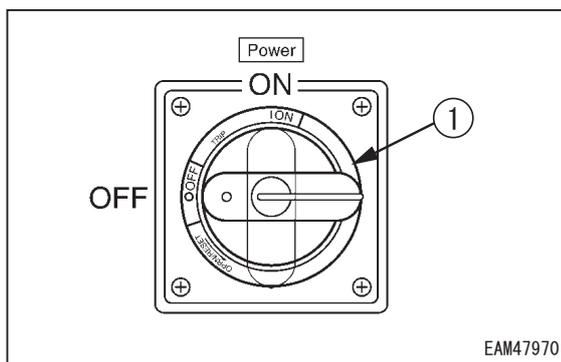
6. メインブレーカスイッチ (1) を OPEN/RESET の位置にし、ハンドル (4) を手前に引いてロックを外し、電源ボックス (2) のドア (3) を開けてください。
