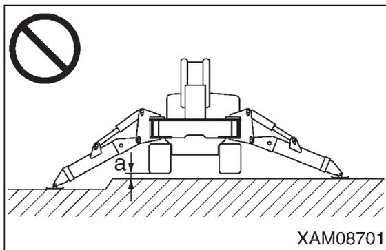
定格総荷重表の「アウトリガ最小張出」状態は、下図の状態を示します。
