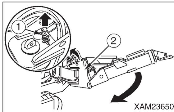
2. アウトリガロータリ (2) を内側に回転後のピン穴位置が合ったところで、ポジションピン (1) を根元まで確実に挿入してください。
