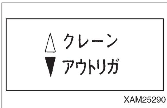
4. 操作モードが「アウトリガモード」に設定され、「アウトリガマーク」が表示されます。その後、「アウトリガ接地モード」に設定され、「アウトリガ接地モード」が表示されます。
