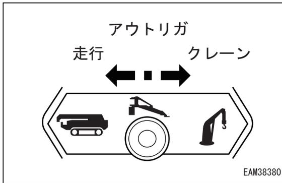
☞ 下表は、作業切換スイッチの操作位置とその動作可能装置の関係を示します。
