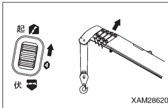
7. フック巻上、巻下操作レバーを「下」側（下方）および「上」側（上方）にそれぞれ操作してアクセルレバーを引いたとき、フックが操作レバーの操作に対応した作動をするか確認してください。
