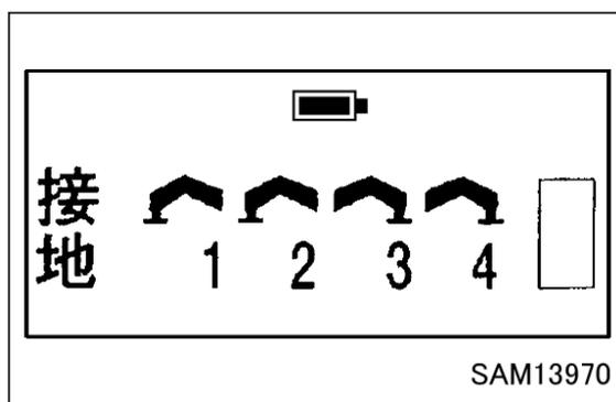
5. 「アウトリガ張出モード」に設定するときには、「アウトリガ接地モード」画面の状態です。速度/モードスイッチを押してください。「アウトリガ張出モード」に設定され、「アウトリガ張出モード」が表示されます。
