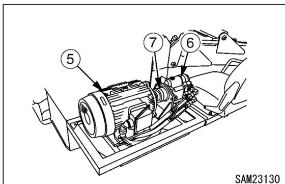
4. 電動ユニット周りに枯れ葉、紙屑、ホコリなどが堆積、付着していないか点検してください。
