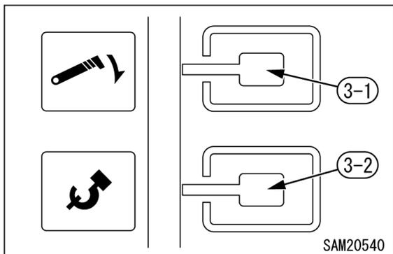
☞ スイッチを押している間だけ格納動作します。
