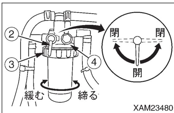
4. ヘッド (4) 部のリテーナリング (3) を左方向に回して緩め、ポット (1) をヘッド (4) 部から取り外してください。
