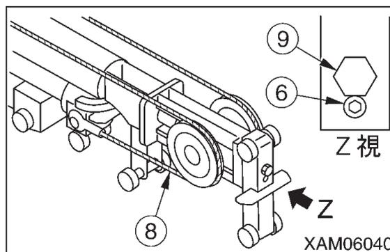
4. ブームを水平状態にして、全縮時に No.4、No.5 ブーム間のスキマ (下図のスキマ (a)) が 5mm 以上あるか、点検してください。スキマが 5mm 以上ある場合は、「ワイヤロープの調整」の項を参照して調整してください。
