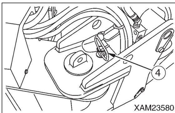
☞ アウトリガロータリ張出操作後、ポジションピン (4) が確実に差し込まれているか確認してください。
