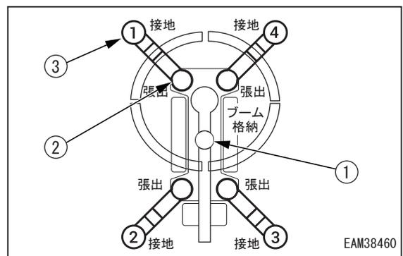
☞ アウトリガ表示部内のブーム格納ランプ (1)、アウトリガ張出ランプ (2)(4個) が緑色点灯しています。
