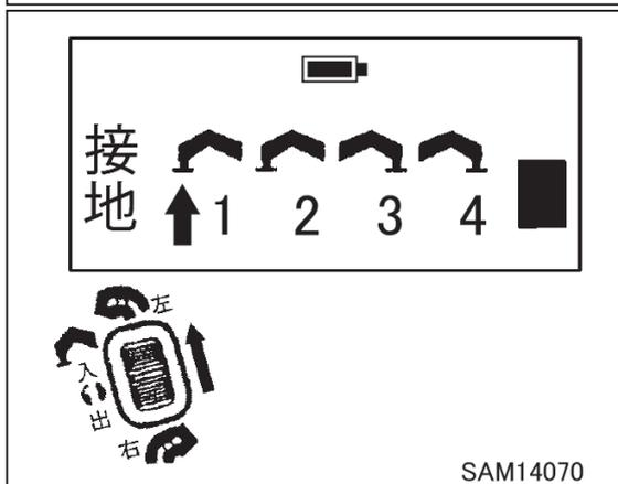
12. 操作レバーの操作中、同時にアクセルレバーをゆっくり引いたり戻したりし、No.1 アウトリガがアクセルレバーの操作量に対応した作動速度になるか確認してください。
