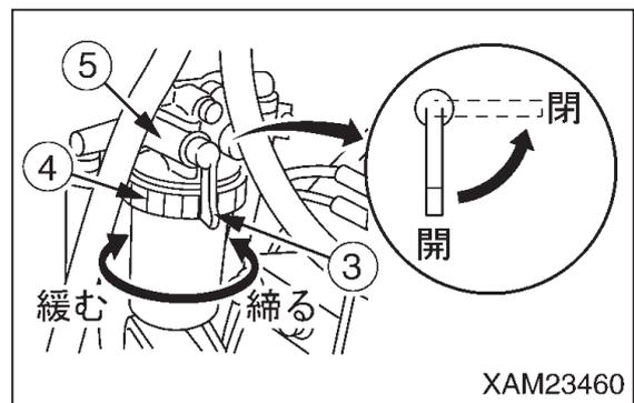
5. ヘッド (5) 部のリテーナリング (4) を左方向に回して緩め、ポット (1) をヘッド (5) 部から取り外してください。
