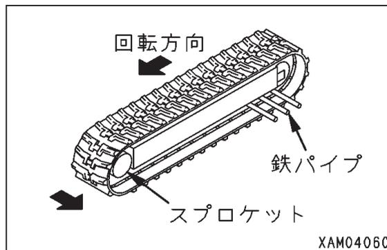
5. 鉄パイプによってアイドラからゴムクローラが浮いたら、横方向にスライドさせて外してください。
