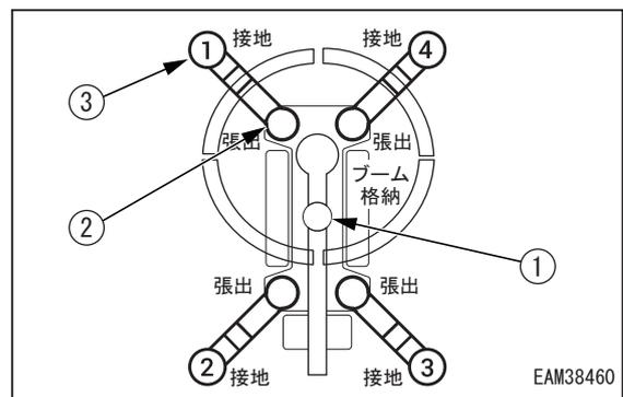
☞ アウトリガ表示部内のブーム格納ランプ(1)(緑色)は点灯し、アウトリガ張出ランプ(2)(4個)は緑色で点灯し、アウトリガ接地ランプ(3)(4個)は赤色で点灯しています。
