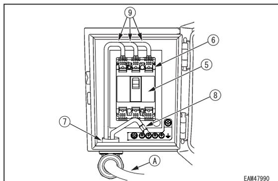
7. 本機械の仕様に合ったキャブタイヤケーブル (A) を電源ボックス下部のケーブルグラウンド (7) の穴に通して、メインブレーカ (5) に接続してください。
