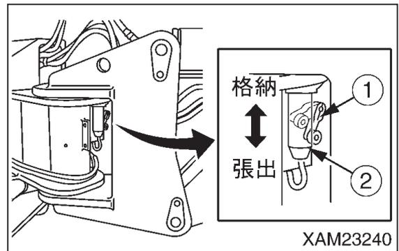
☞ ポジションピン (2) の抜き差しは、アウトリガロータリ部の検出スイッチ (1) により検出されます。
