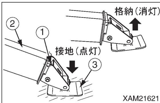
☞ アウトリガの受け皿 (3) の状態は、インナーボックス (2) 先端部の検出ピン (1) とインナーボックス内部の検出スイッチにより検出されます。
