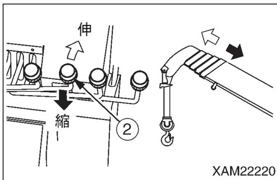
☞ ブームの伸縮速度は、ブーム伸縮レバーおよびアクセルペダルのストロークによって調整してください。
