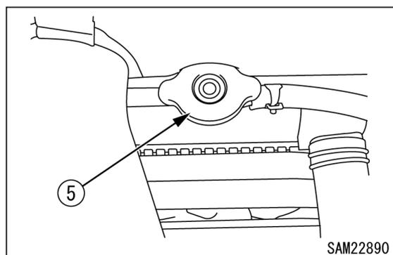
3. ラジエータの水位レベルが低かった場合は、ラジエータ、ラジエータホースおよびエンジン各部からの水漏れを点検してください。
