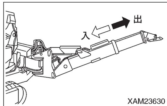
3. アウトリガ操作盤内の作業切換スイッチ（アウトリガ起伏/伸縮）を「アウトリガ起伏」位置にしてください。
