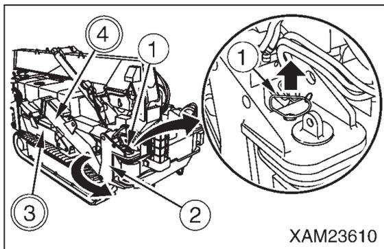
6. アウトリガロータリ (2) を外側に回転後のピン穴位置が合ったところで、ポジションピン (1) を根元まで確実に挿入してください。
