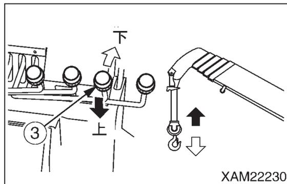
7. ブーム起伏レバー (4) を前後にゆっくり操作して、起伏シリンダがストロークエンドになるまで上昇、下降させ、作動具合に異常がないか点検してください。異常があれば修理してください。
