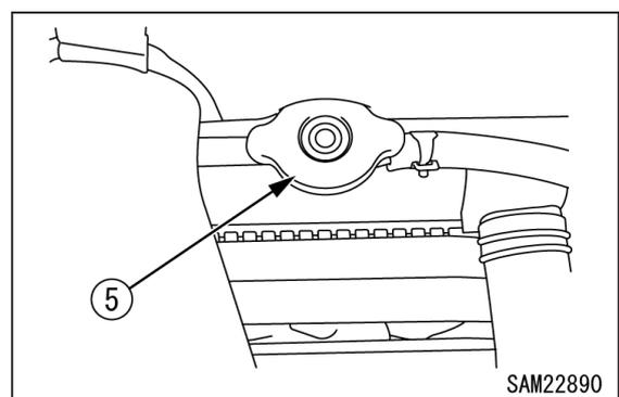
18. エンジンを停止して約3分間待った後、ラジエータ給水口から水道水を注入して給水口近くまで満たし、ラジエータキャップ(5)を閉めてください。
