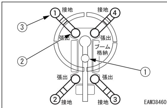
5. アウトリガロータリ (2) のポジションピン (1) を抜き出し、アウトリガロータリを外側に回転させてください。
