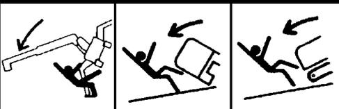
クレーン作業時に車体が3°以上傾いた時、または走行時に車体が15°以上傾いた時に傾斜警報ブザーが鳴ります。
