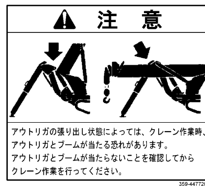
(20) アウトリガ張り出し時の注意(359-4477200) (6箇所)
