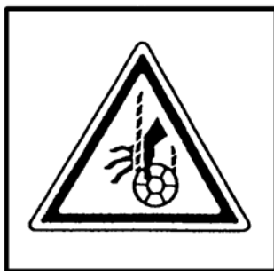
(33) フックブロック巻き込まれ注意 (553-4267400) (2箇所)
