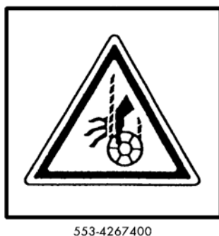
(19) フックブロック巻き込まれ注意(553-4267400) (2箇所)
