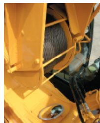
●フラットサーフェイスブーム ●ブーム下抱きウインチ、乱巻き防止用ミラー付
