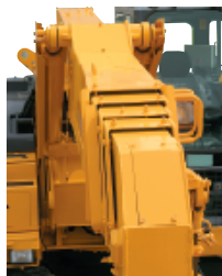
●フラットサーフェイスブーム ●ブーム下抱きウインチ、乱巻き防止用ミラー付
