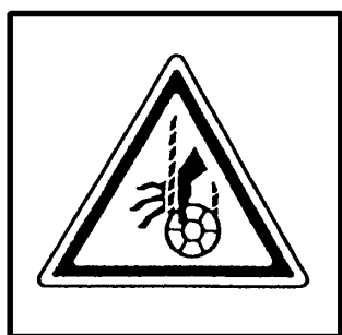
(29) フックブロック巻き込まれ注意(553-4267400) (2箇所)
