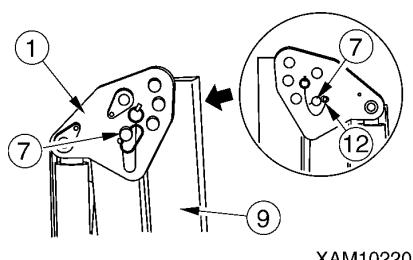
6. 連結ブラケット(1)の1番外側の穴にポジションピン(7)を差し込み、先端のスナップピン(12)で抜け止めをしてください。
