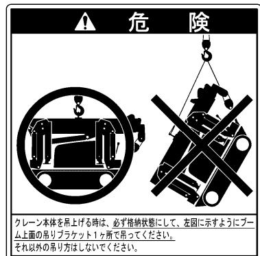
クレーン本体を吊り上げる時は、必ず格納状態にして、左図に示すようにブーム上面の吊りブラケット1ヶ所で吊ってください。
