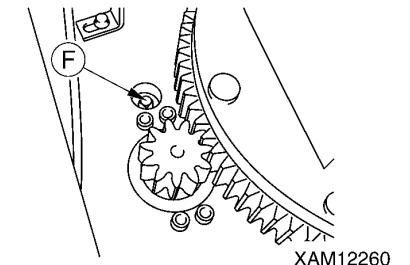
6. オイルの点検・補給後は、給油プラグ(F)を確実に締め付けてください。
