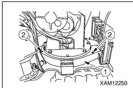
4. 旋回減速機ケースの給油プラグ(F)を外し、プラグ穴に指を入れてオイルがプラグ穴の口元まで入っているか点検してください。
