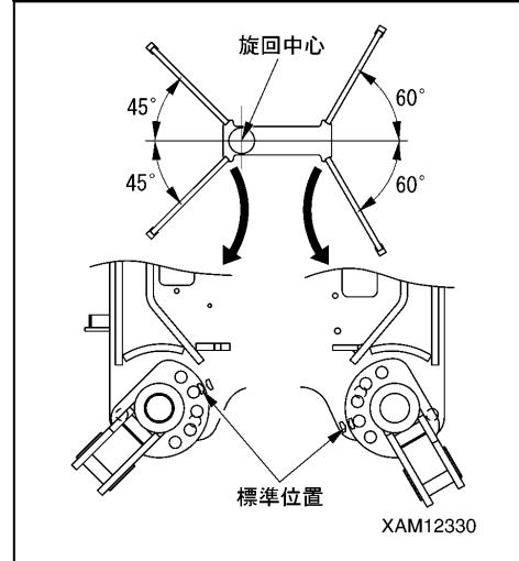
4. 連結ブラケット(1)のポジションピン(7)先端のスナップピン(12)を外し、ポジションピン(7)を抜き取ってください。
