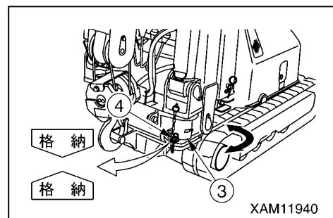
2. アウトリガロータリ(3)を回して、アウトリガロータリ(3)側面に貼られているシール「標準」とフレーム側面に貼られているシール「標準」とを合わせてください。
