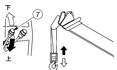
10. 旋回レバー(2)を前後にゆっくり操作して、クレーンが左右にそれぞれに360度以上スムーズに旋回するか、旋回レバーを「中立」位置に戻したとき、クレーンがすぐに停止するか点検してください。
