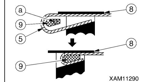
このとき、ワイヤロープ(5)の先端がウインチドラム(8)の穴の狭い側からはみ出さないようにワイヤロープの長さを調整してください。
