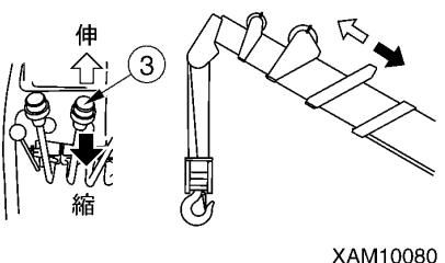
9. ウインチレバー(7)を前後にゆっくり操作して、フックブロックがスムーズに巻き上げ、巻き下げするか、ウインチレバーを「中立」位置に戻したとき、フックブロックがすぐに停止するか、ウインチドラムが乱巻きしないか点検してください。
