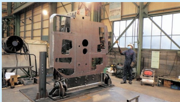
治具を用いたレボフレーム反転作業
