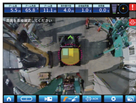
クレーンの周囲360°の安全が確認できるマルチアシストビュー
