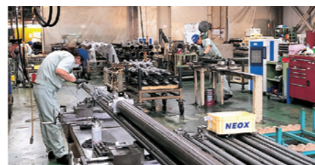
シリンダ組立・検査工程
