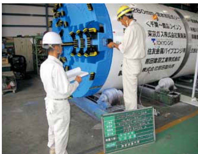
Φ2280泥水加圧式シールド掘進機
