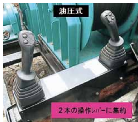
機械式に比べ簡素化された油圧式の操作レバー
