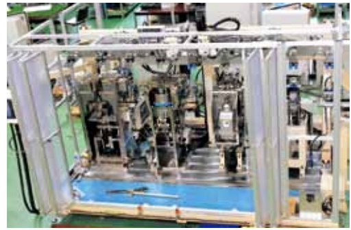
自動車空調アルミパイプ自動成型ライン 自動車エアコン用のアルミパイプを加工する自動ライン設備の完成立会状況。 生産性向上を満足できる設備かを検証。
