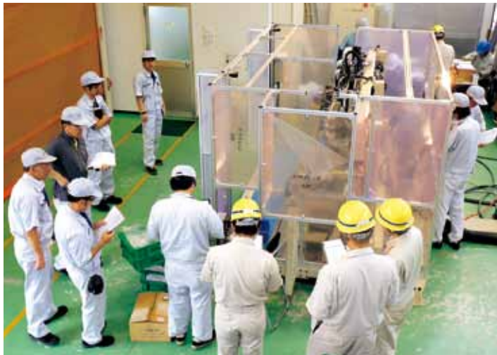
自動車空調アルミパイプ自動成型ライン 自動車エアコン用のアルミパイプを加工する自動ライン設備の完成立会状況。 生産性向上を満足できる設備かを検証。
