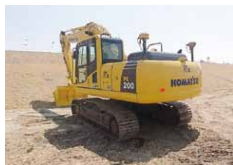
バックホウマシンガイダンス (PC200)
