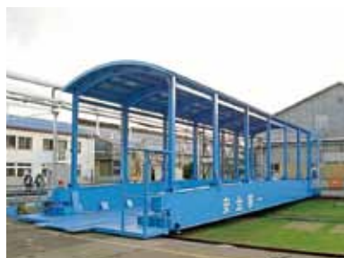
鉄道車両移動用 トラバーサー
