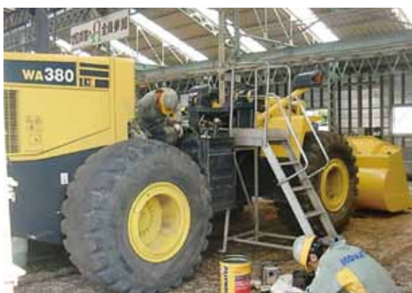
(ポンプ交換作業)
