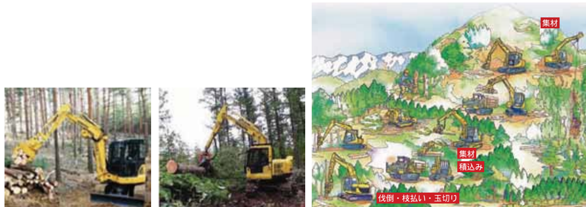
左 PC55MR-3林業グラップル・ウインチ仕様車 右 PC138US-8ハーベスタ・プロセッサ仕様車
