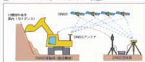
図2 GNSSシステム(マシンガイダンス)概要
